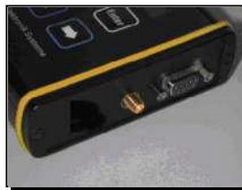
Abb. 3.2: Funkmodem mit einem Antennenanschluss
