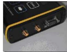
Abb. 3.3: Funkmodem mit zwei Antennenanschlüssen
